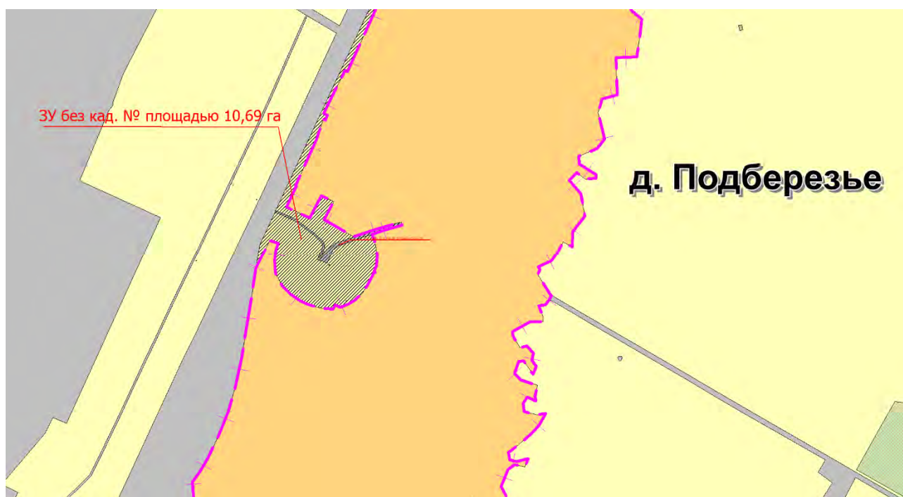
Рис. 2.2.2.13. Схема территории населённого пункта д. Подберезье, расположенной в границах зоны минимальных расстояний магистрального газопровода «Белоусово-Ленинград»
